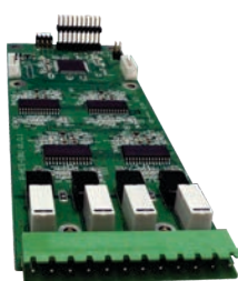
AES/EBU kartica (Mono ulaz/Izlaz, Stereo Ulaz/Izlaz, Dupleks Stereo)
